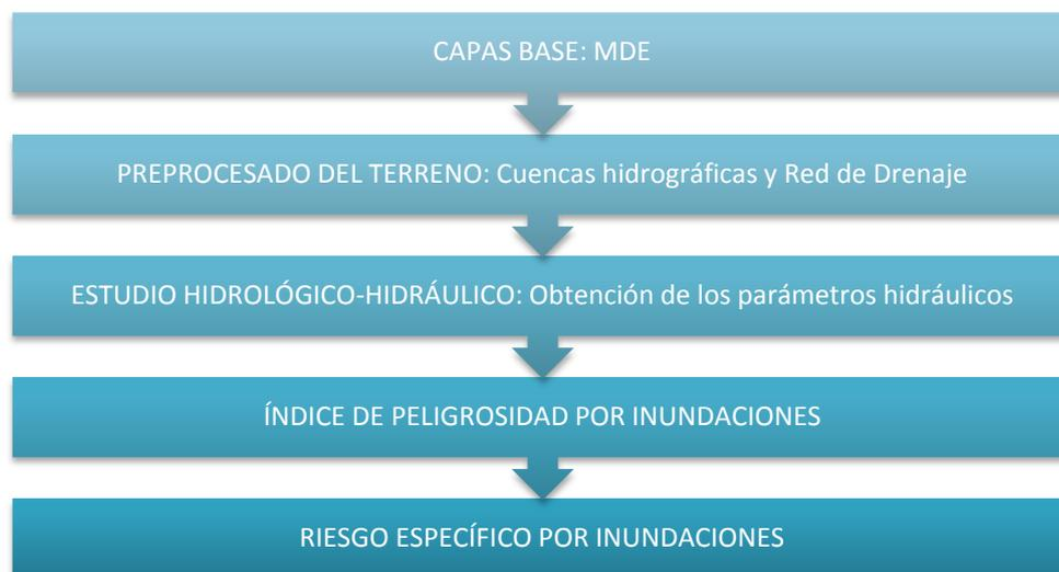
Figura 5. Esquema básico del Modelo Conceptual del Módulo de Inundaciones
